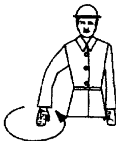
Рисунок 5. Опускание
