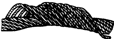
Рисунок 10. Корзинообразная деформация
