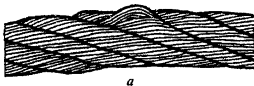
Рисунок 11. Выдавливание сердечника
