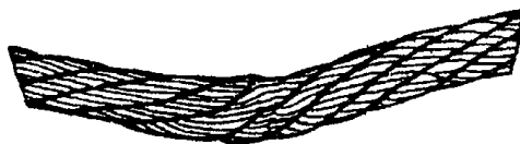
Рисунок 16. Залом каната
