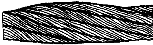
Рисунок 13. Местное увеличение диаметра каната
