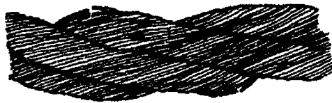
Рисунок 1. Обрывы и смещения проволок каната крестовой свивки
