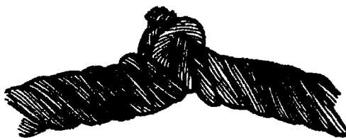
Рисунок 15. Перекручивание каната
